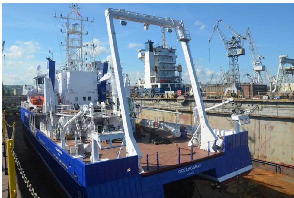
Rys. 5. Oceanograf widziany od rufy. Widoczna bramownica rufowa i dwa wychylne żurawiki rufowe.
